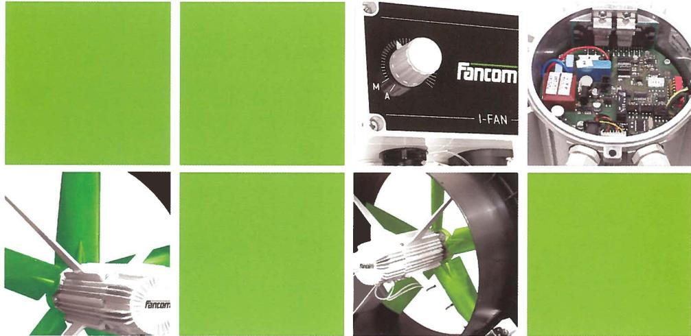
Les ventilateurs I-fan sont économes en énergie grâce à l'utilisation de moteur EC (Commutation électronique) à courant continu (sans balais et à aimants permanents). L'électronique intégrée régule le moteur en fonction du signal de commande, et assure une vitesse et un couple constant quelques soient les variations de pression. La ventilation
